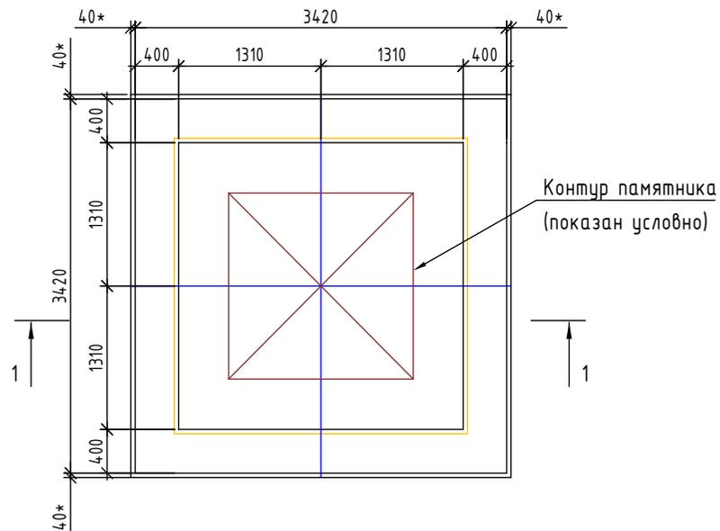
Схема расположения элементов монолитного фундамента
